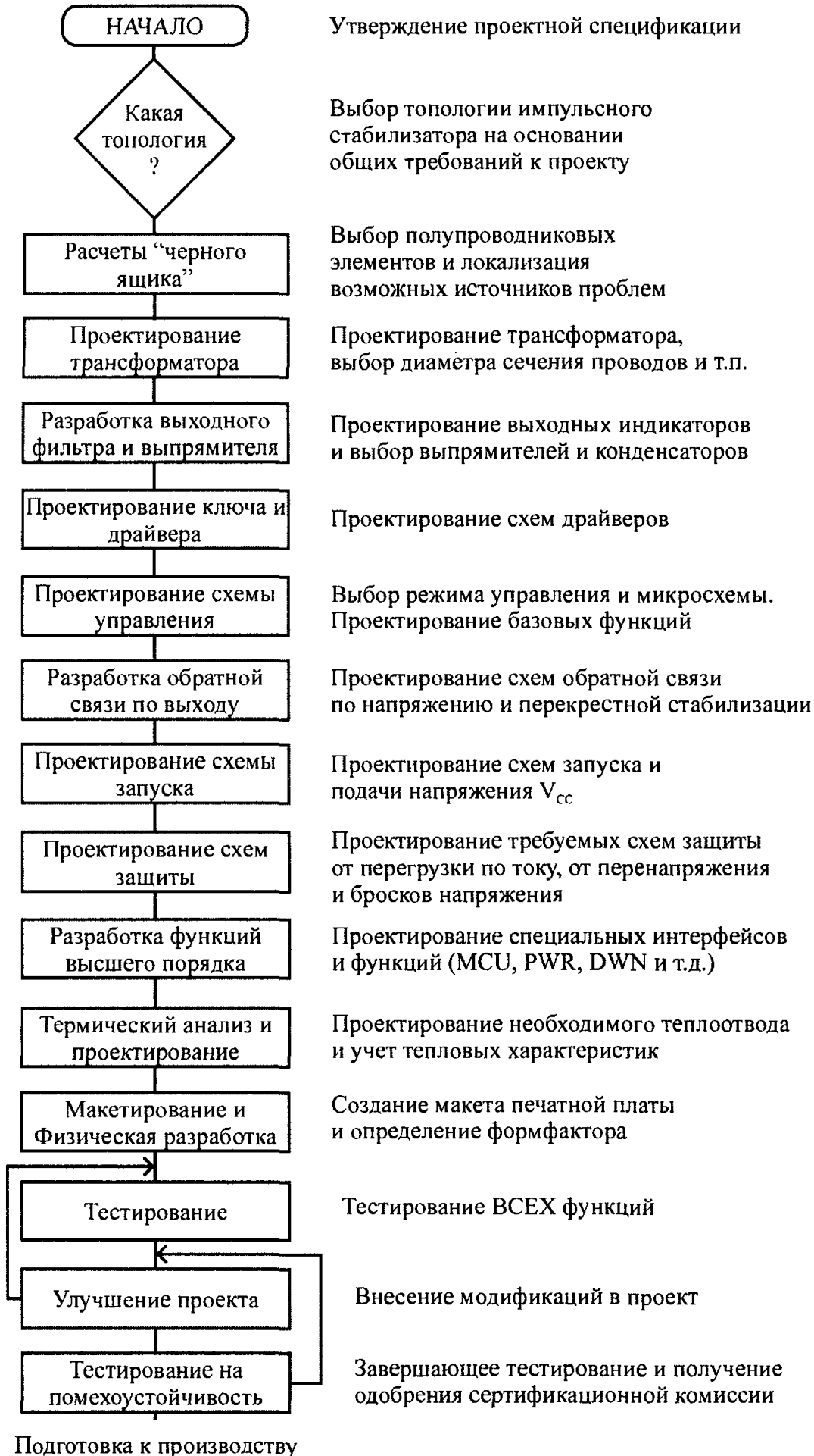
Рис. 3.6. Блок-схема последовательности разработки импульсного источника питания с ШИМ
