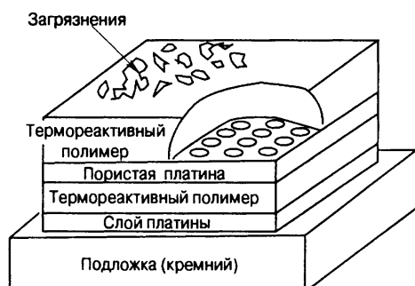
Рис. 10.40. Конструкция датчика относительной влажности NIN-3602
