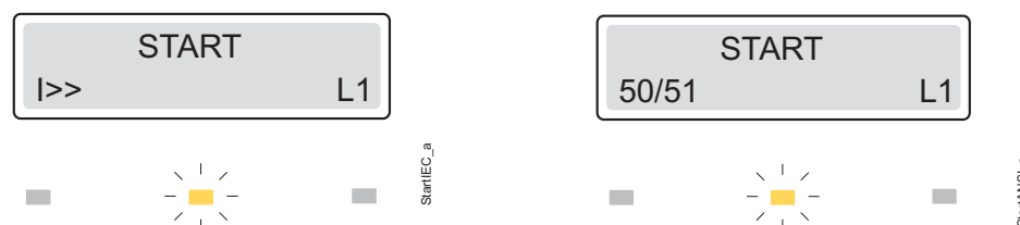
Рис. 3.3.2.1.-1 Индикация пуска с фиксацией (режимы IEC/ANSI)
