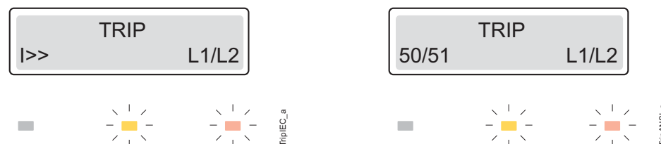
Рис. 3.3.2.1.-2 Индикация срабатывания (режимы IEC/ANSI)
